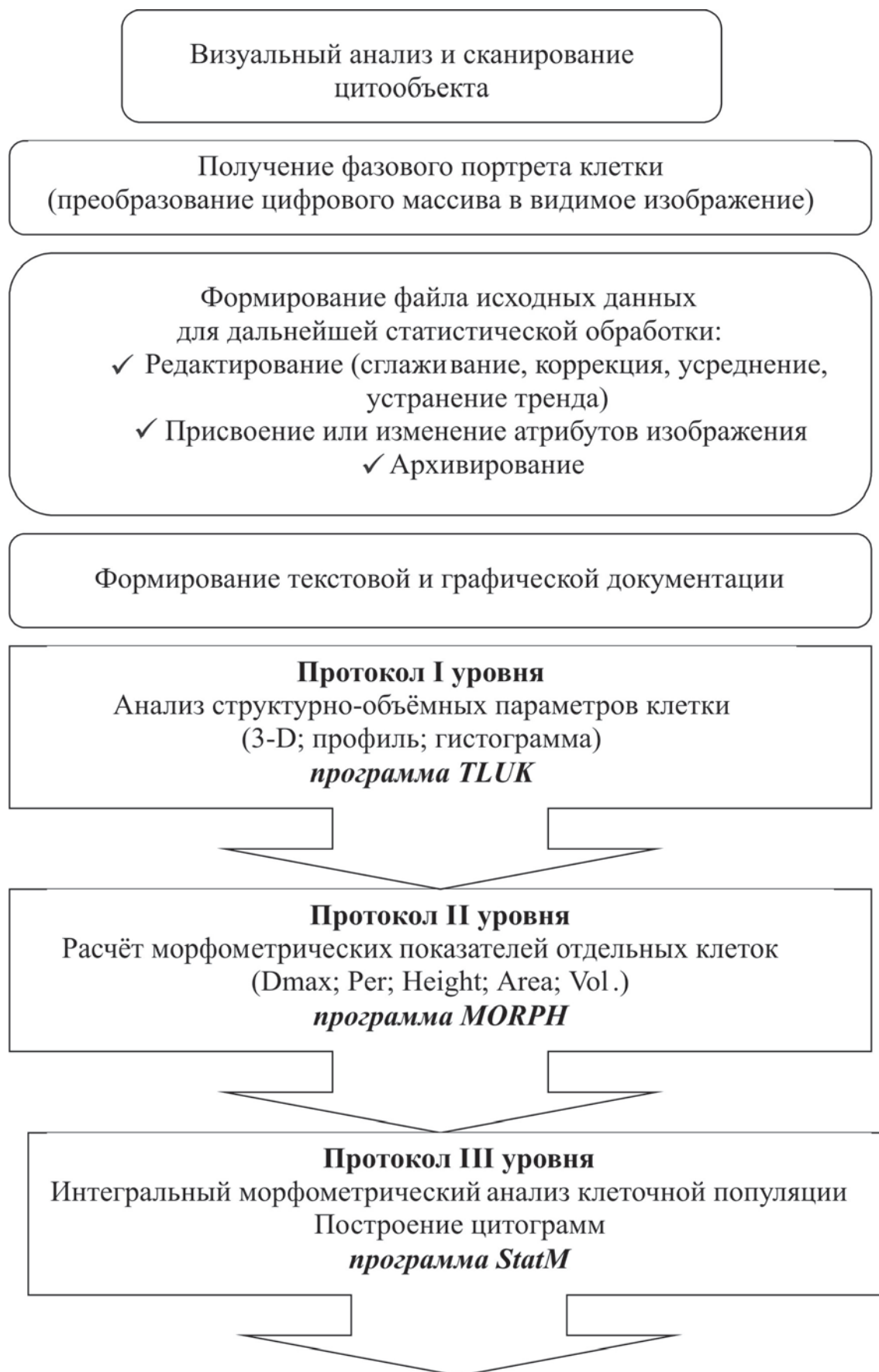
Рис.2. Блок-схема алгоритма витальной компьютерной интерферометрии
