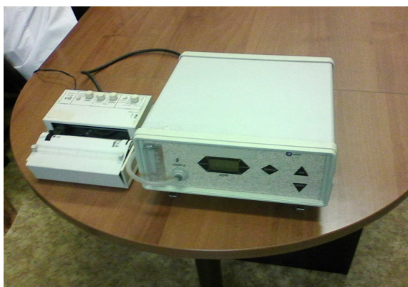
Рис. 1. Внешний вид «Галимета» (Halimeter, США) с чернильным самописцем
